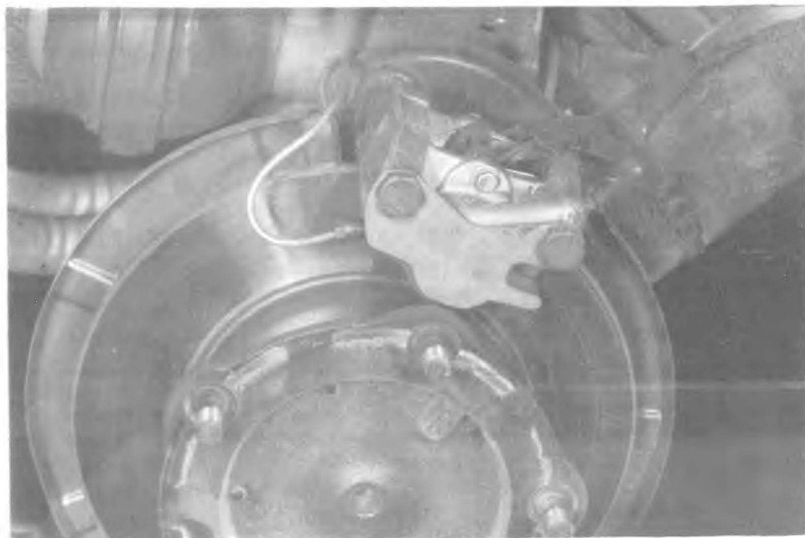
Nouvel étrier arrière - Hinterer Bremsträger neuer Bauart - New rear brake caliper - Nuevo modelo de estribo trasero Nuova staffa posteriore
