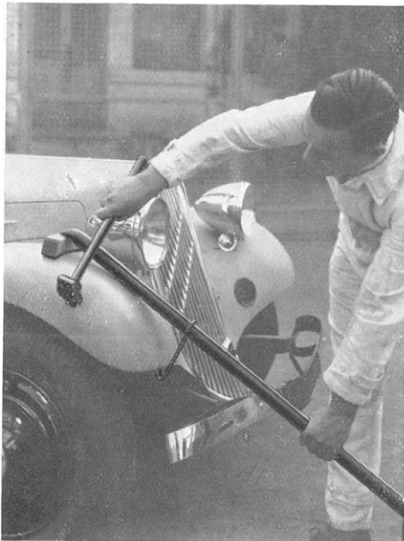
Fig. 4. — Débosselage d'une aile.
