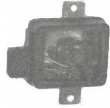
Contacteur sur sur axe de papillon
