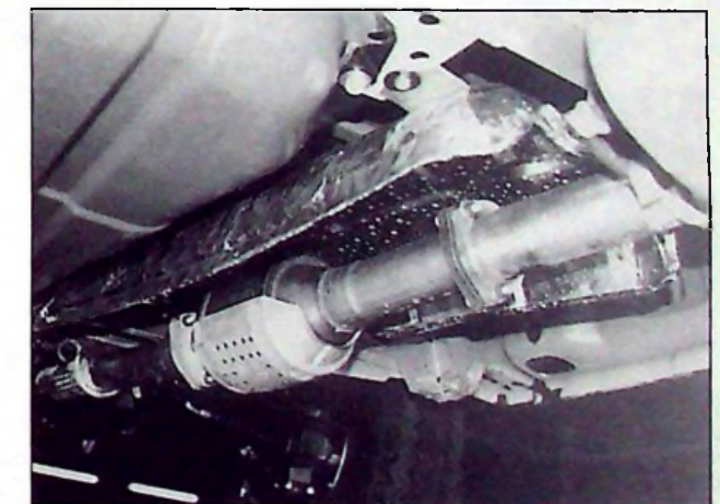
Le catalyseur et son écran thermique
