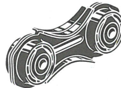
Rear engine suspension rod Biellette de suspension AR moteur 524508 Var. 61 côté droit Coefficient 1 524508 Var. 62 côté gauche Coefficient 1
