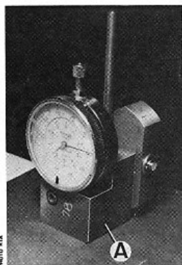
Etalonnage du comparateur A. Support de comparateur
