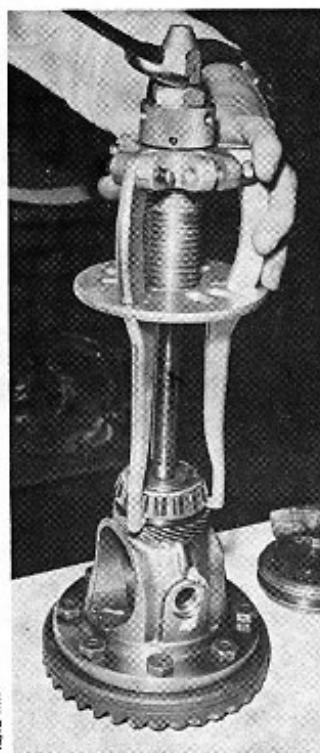
Dépose des roulements de différentiel
