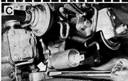
Réglage du ralenti A. Moteur 1130 - B. Moteur 1300 - C. Réglage de la richesse
