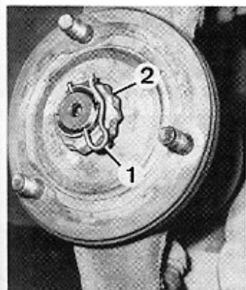
Fixation de la transmission sur le moyeu
