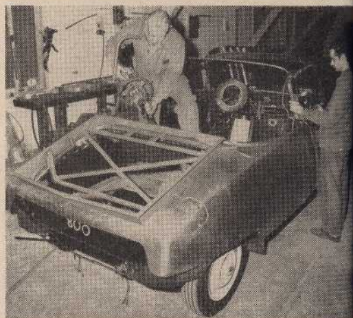
← Fig. 21. — Soudage de la ceinture de dormant.
