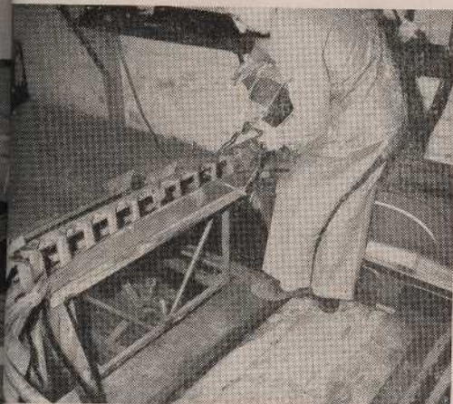
→ Fig. 14. — Montage de la cornière AR de fixation de revêtement. Montage des tôles de liaison sur passage de roue pour fixation revêtement.
