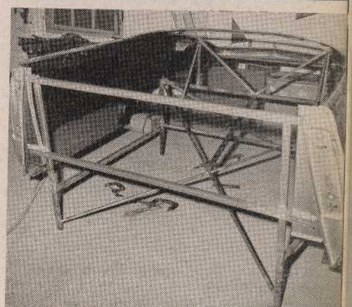
← Fig. 17. — Montage du support de plaque mobile de capotage.
