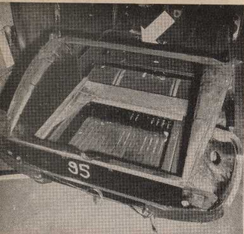
← Fig. 3. — Mise en place des dispositifs de protection des organes de suspension hydraulique. La flèche indique la modification de la tablette AR destinée à recevoir la ceinture de dormant.
