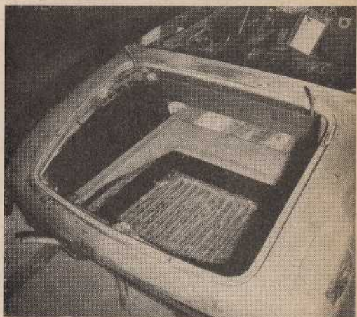
→ Fig. 29. — Gabarit de positionnement des portes, capotage en position, réglage des jeux, etc. Remarquez la soudure apparente sur le panneau, nécessitée par le rallongement de la porte (la flèche indique le gabarit).
