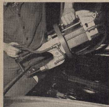
← Fig. 23. — Soudage de la jupe AR sur tôle de gâche pour couvercle de malle.
