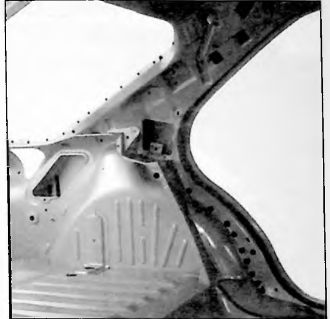
Fig. 92768-1C Souder par points "bouchon" MAG. Disquer les points.
